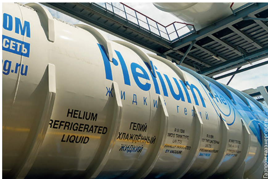
Автомобильная цистерна-контейнер, разработанная в России по заказу «Газпрома», для транспортировки жидкого гелия
