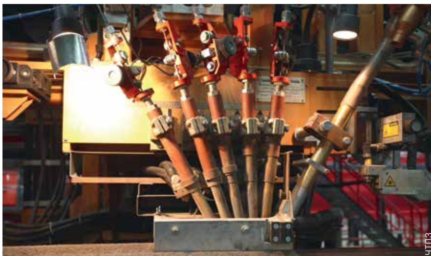
Сварка под флюсом на производстве ЧТПЗ
