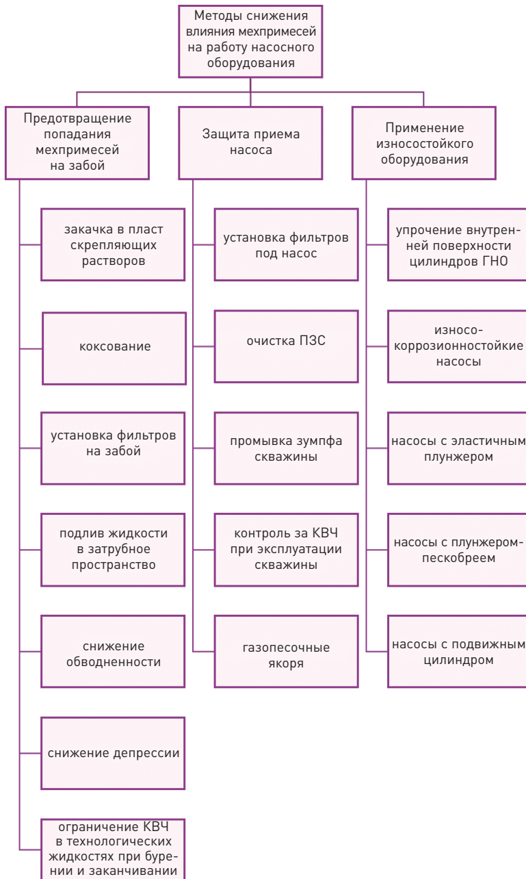
Рисунок 3 Методы защиты внутрискважинного оборудования [6]
